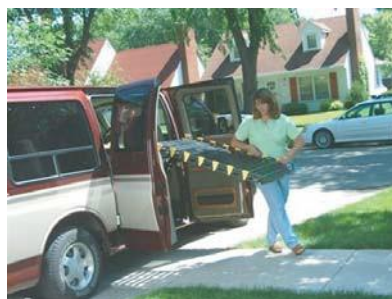
Rullaramppi autoon. Rampin voi kiinnittää autoon käsi käyttöisenä tai sähköisesti toimivana. Samaa ramppia on mahdollista käyttää myös siirrettävänä ramppina.
