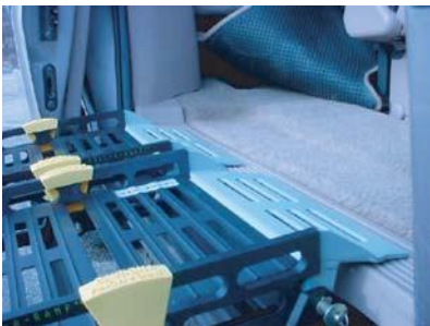
Lähestymisluisa kantava #3212, 3235, 3236. Varmistaa matalan lähestymisen rampin yläpäässä.
